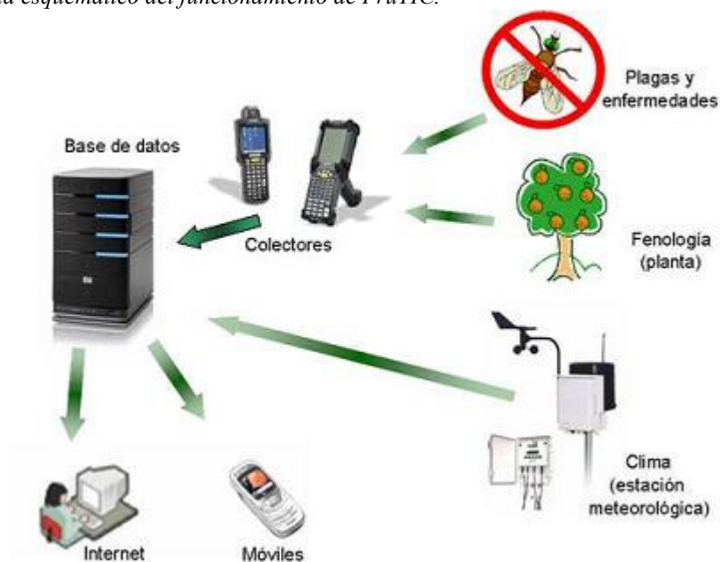
Figura 2. Diagrama esquemático del funcionamiento de FruTIC.
