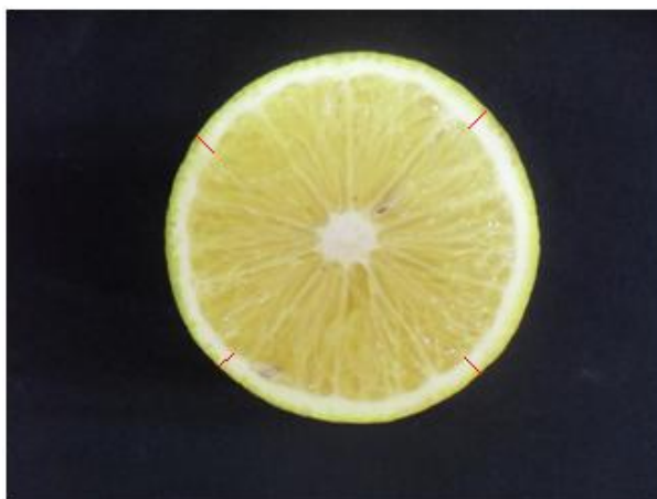
Figura 8: Lugares donde se midieron espesores con calibre en el ejemplar
